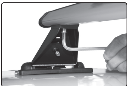
Překontrolujte utažení šroubů M8x18 příloženým klíčem (imbus č.6).
