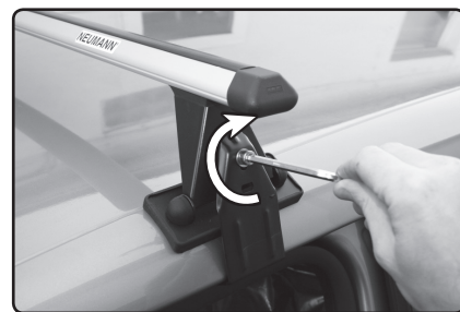
Pevně utáhněte šroub M8x35 příloženým klíčem (imbus č.6) rovnoměrně na obou stranách nosníku. Šroub neutahujte nadměrnou silou, aby nedošlo k deformaci bočního úchytu a špatnému upevnění nosiče.
