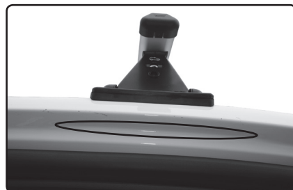
V rámu karoserie jsou nad dveřmi prolisy, nad které se umísťují střešní nosiče.
