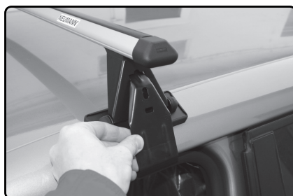
Trn na spodní hraně bočního úchyty nasadíte do otvoru v rámu karoserie a zároveň zasuňte boční úchyt do patky nosiče.
