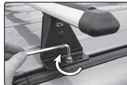
Šrouby M8x18 pevně utáhněte přiloženým klíčem (imbus č.6).
