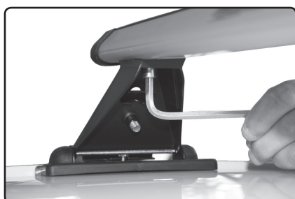
Překontrolujte pevné utažení šroubů M8x18 příloženým klíčem (imbus č.6). Rozteč šroubů M8x18 s imbusovou hlavou, které fixují patku nosiče k tyči by měla odpovídat rozteči „D“.
