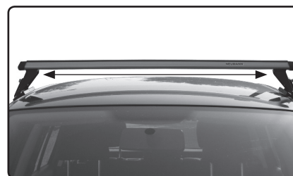
Pevně utáhněte šroub M8x35 příloženým klíčem (imbus č.6) rovnoměrně na obou stranách nosníku. Šroub neutahujte nadměrnou silou, aby nedošlo k deformaci bočního úchytu a špatnému upevnění nosiče.
